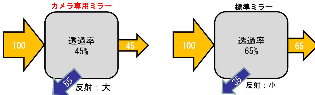
カメラ専用ミラーは標準付属ミラーよりも透過率が低いため、より多くの光を反射できます。そのため、反射の精度が上がり、文字を明るくハッキリ読むことが可能です。
